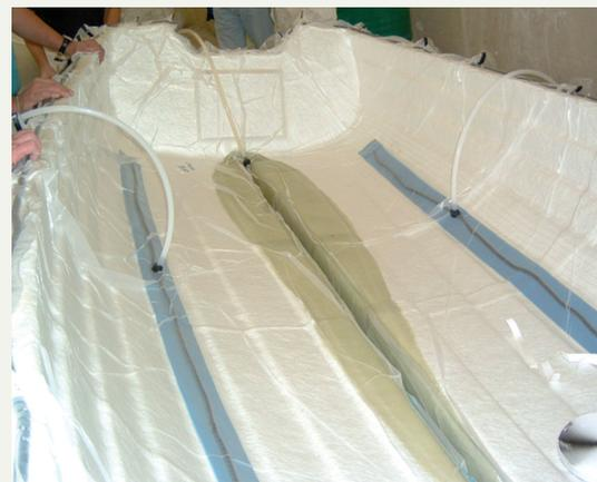
Fig. 3 Scott Bader offre la serie di resine Crystic per stampi chiusi con infusione a vuoto, RTM leggero e RTM
