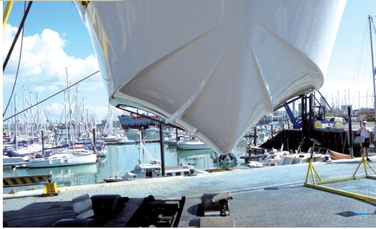
Fig. 5 Daedalus 30 è stato costruito interamente con i prodotti Scott Bader basati sul sistema combinato Crystic per uso nautico, che comprende il gelcoat LS31PA iso/npg, il rivestimento barriera Crestacoat 5000PA e lo skincoat VE679PA vinilestere/DCPD
